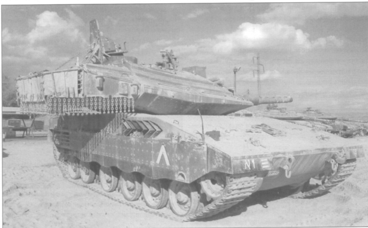
Een Merkava 4 die is ingedeeld bij de cavalerie school in de Negev woestijn. De stoel op het torendak is bestemd voor de instructeur
