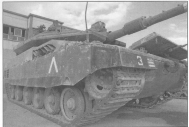
Een close-up van de rupsband van een Merkava Mk 4. Let ook op de vorm van het rooster voor de uitlaat.
