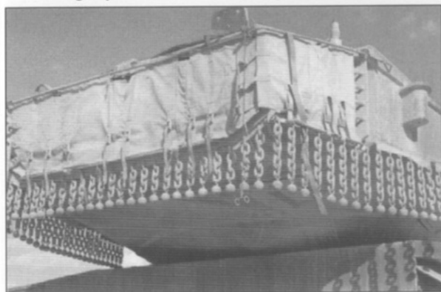
Twee detailopnames van de toren: de ketting-en-bal bescherming tegen RGP's rond de achterkant (↑) en het luik van de commandant (→).
