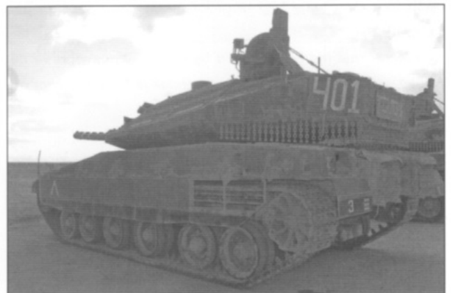
In het achterste deel van het zijpantser zitten enkele horizontale spleten, die de bemanningsleden gebruiken om op de tank te klimmen. Ook geeft het een kleine gewichtsbesparing.
